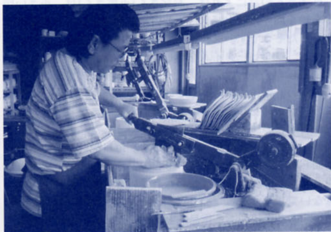
水ゴテを使った作業。ダボ(石こうで作られた置台)の上に外型をのせ、そこに地のべしたタタラをのせて水を使いながら成形する。
